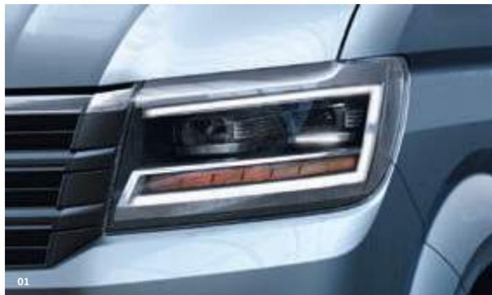
**01 Светодиодные фары.** Яркие, с низким уровнем энергопотребления и огромным сроком службы, полностью светодиодные фары, обеспечивающие ближний / дальний свет и режим дневных ходовых огней, делают автомобиль более заметным для других участников движения, а передвижение в тёмное время — более безопасным: водитель лучше видит и меньше устаёт, всматриваясь в дорогу. Спектр излучения LED-фар близок к дневному солнечному свету. | [КА](#) | [PR](#) | [Ш](#) |
