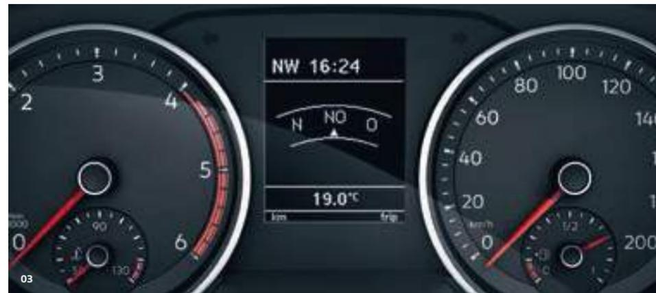
**03 Многофункциональный дисплей Plus.** Контрастный монохромный дисплей обеспечивает водителя разной полезной информацией: показывает запас хода, время в пути, температуру за бортом и оптимальную для экономии топлива передачу, а кроме того, упрощает настройку различных вспомогательных систем автомобиля. Например, позволяет выбрать наиболее комфортный алгоритм работы центрального замка. | KA | PR | Ш |
