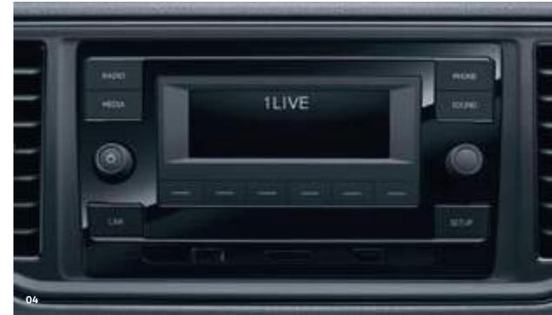
**04 Инфомедиа-система Composition Audio.** Включает монохромный дисплей, большие удобные клавиши прямого доступа к основным функциям, два динамика (два канала по 20 Вт), слот для SD-карт, USB-разъём и опциональный Bluetooth-канал для беспроводного подключения мобильного телефона и разговоров по нему в режиме громкой связи | KA | PRO | Ш |
