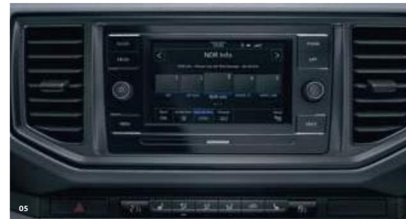
**05 Инфомедиа-система Composition Colour.** Включает цветной сенсорный дисплей диагональю 6 дюймов, четыре динамика (четыре канала по 20 Вт), слот для SD-карт, вынесенный на переднюю панель USB-разъём прогрессивного типа C, Bluetooth-канал для беспроводного подключения телефона. Функция App-Connect позволяет расширить функционал системы за счёт подключения смартфона с выходом в интернет (подробнее на стр. 63). | KA | PR | Ш |
