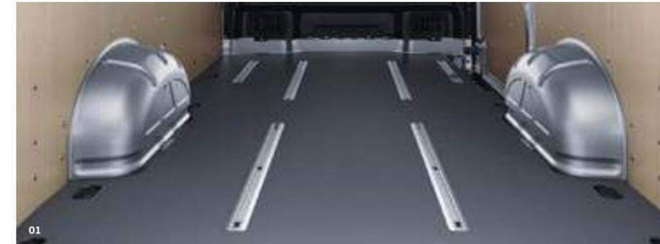
**01 Пол из буковой фанеры.** <sup>1)</sup> Прочное многослойное износостойкое ламинированное покрытие толщиной 8 мм защитит стальную панель пола от вмятин и царапин. Доступ к такелажным петлям остаётся свободным. | КА |
