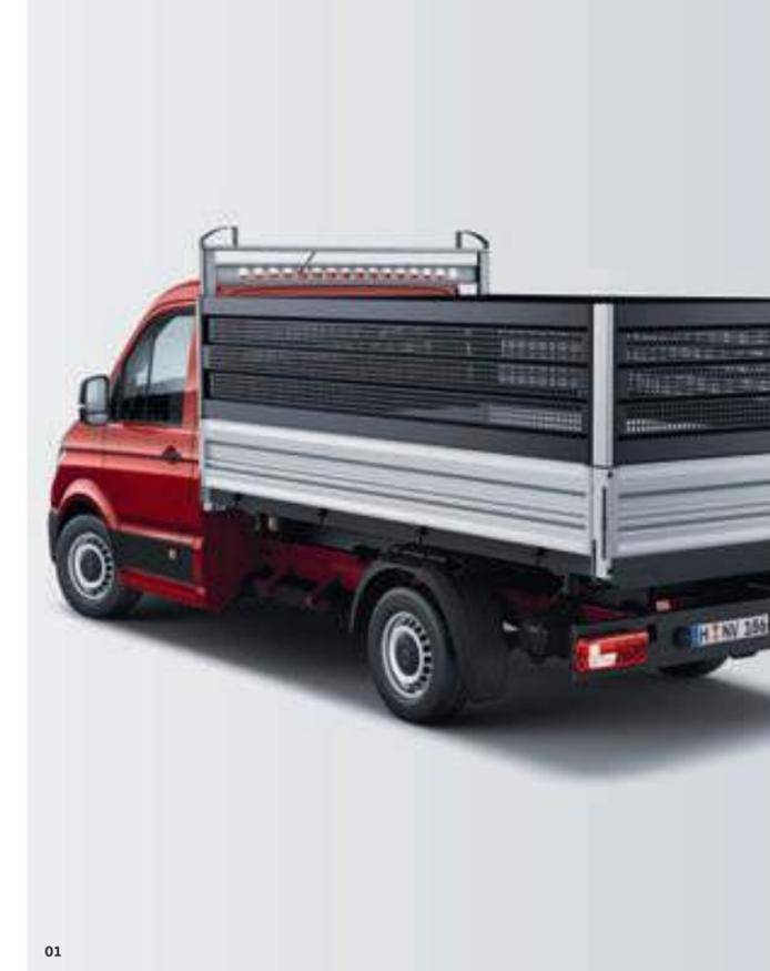
**01** Комплект для увеличения высоты бортов открытого кузова. Идеальное решение для перевозки относительно лёгких сыпучих материалов, например древесной щепы. Сетчатая стальная конструкция надёжно защищена от коррозии. Комплект предназначен для обычных бортовых грузовиков и самосвалов на основе Crafter (показан на фото). В обоих случаях сохраняется возможность разгрузки на три стороны. | PR | KP |
