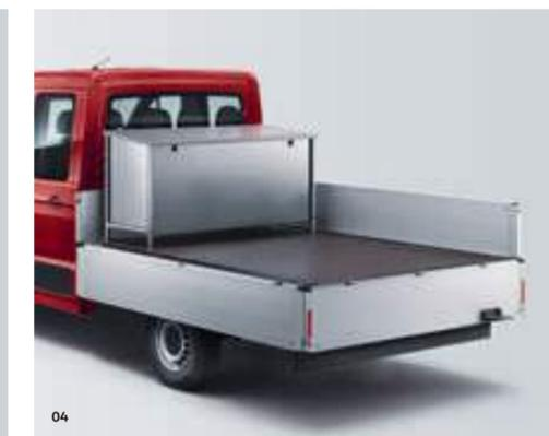
**04** Алюминиевый ящик на платформе<sup>2)</sup> вмещает 640л поклажи весом до 200кг (например, инструмент) и прочно прикреплён к платформе. Открывание крышки — лёгкое и безопасное благодаря газовым пружинам. | PR |
