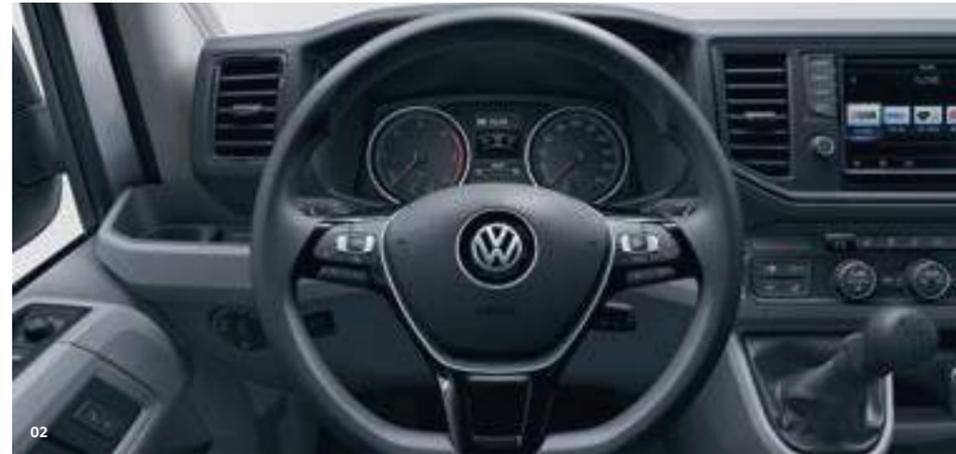
**02 Многофункциональное рулевое колесо.** Рулевая колонка регулируется по высоте и вылету, что позволяет водителю занять оптимальное с точки зрения комфорта и безопасности положение. Клавиши на руле дают возможность управлять инфомедиа-системой, мобильным телефоном, круиз-контролем и бортовым компьютером. | KA | PR | Ш |
