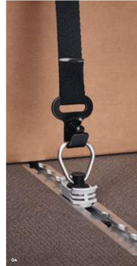
**04 Фитинг для растровой шины.** С помощью показанных на фотографии переходников с крючками вы быстро зафиксируете груз в фургоне, оборудованном крепёжными шинами. Напомним, что в новом фургоне Crafter шины могут быть установлены почти «на 360 градусов»: на боковинах, на полу, на потолке и на перегородке, установленной между кабиной и грузовым отделением. Этого мало? Закажите стойки-распорки в кузов. К ним фитинги тоже подходят. | [KA](#) |
