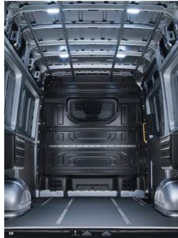
**01 Глухая перегородка.** Сертифицированная по немецким стандартам (DIN 75410-3) для использования в грузовых фургонах перегородка без окна может включать вместительную полку-антресоль<sup>3)</sup> в верхней части кабины (доступ к ней — со стороны грузового отсека). | **КА** |
