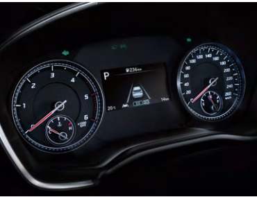
Панель приборов Supervision 4,2 дюйма
