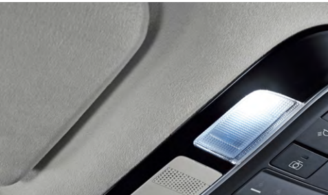
Отделка потолка замшей
